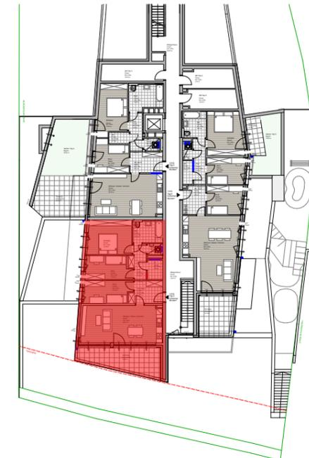
Alle offenbaren Fenster sind Drehkippenfenster, restliche Fenster sind fixverglast. Dargestellte Einrichtungsgegenstände sind unverbindliche Vorschläge, zulässige Bautoleranzen sind möglich, Planmaße sind Rohbaumaße. Einrichtungsgegenstände in Bereichen vor Zuluftelementen dürfen eine maximale Höhe von 2,10m nicht überschreiten. Grundsätzlich sind Einrichtungsgegenstände 5cm von den Außenwänden abzurücken.
